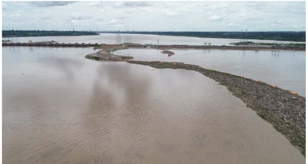
**Log Boom - Boias envoltas em estruturas metálicas ancoradas linearmente na superfície do rio em pilares de concreto.**
