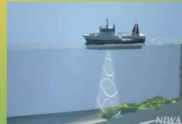
Levantamento Batimétrico Longitudinal
